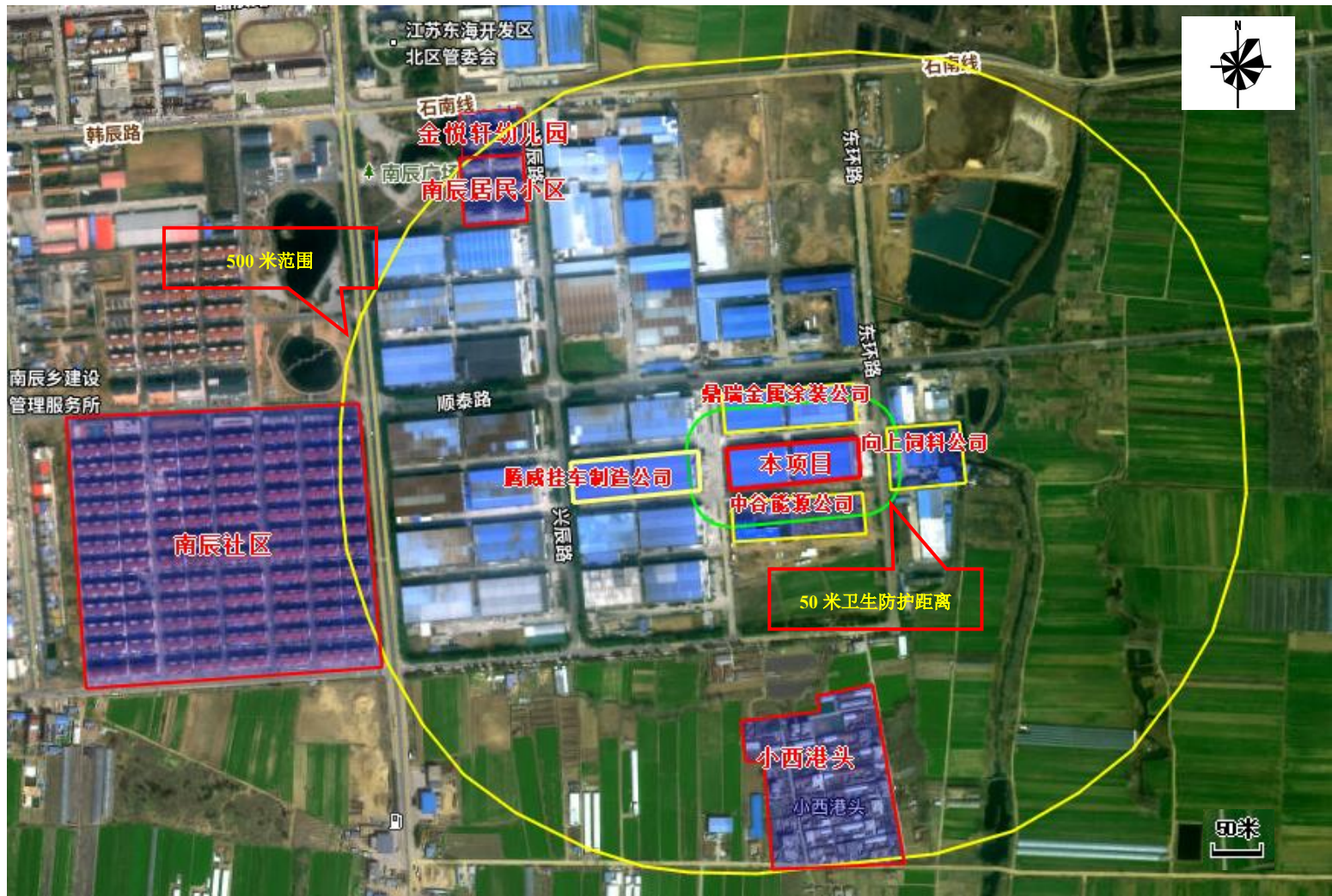
附图 4 项目周边 500m 范围内敏感目标分布及卫生防护距离图
