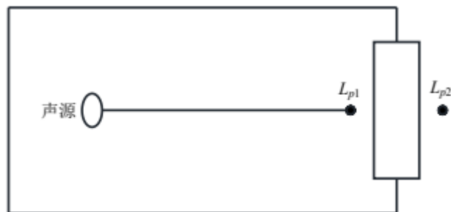
图 4-3 室内声源等效为室外声源图例
